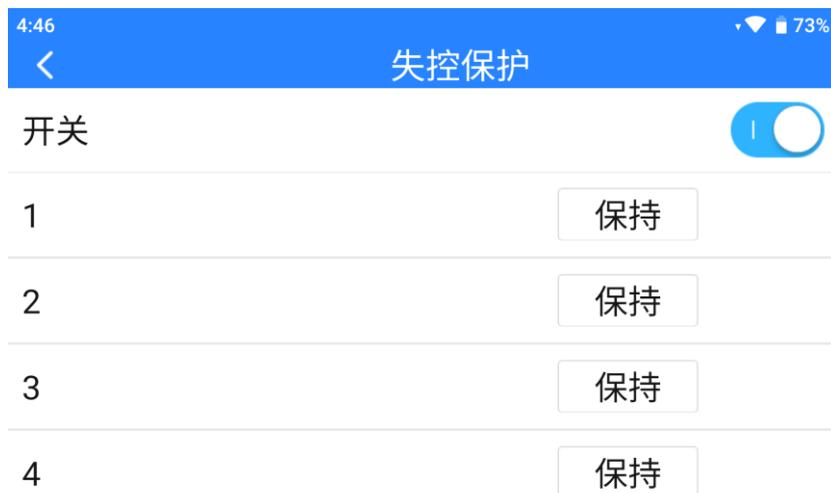
3. 失控保护功能默认关闭，左边的数字代表遥控器的通道，未设定失控保护输出通道值时，遥控器通道默认显示“保持”。
