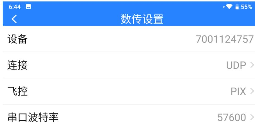
2. 运行 Mission Planner 地面站软件，选择对应端口（UDPCI）及波特率，接口“Port”设置为“19856”，服务器地址“Server Addresses”输入“192.168.144.12”，最后点击连接即可。
