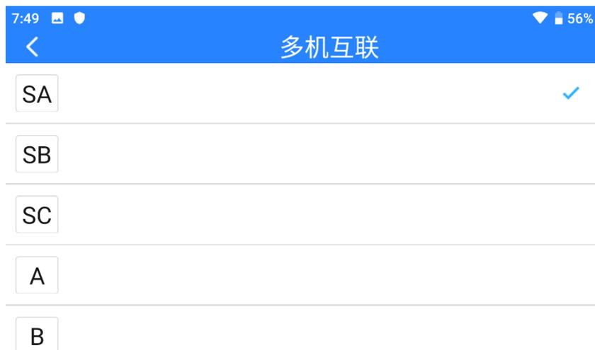
4. 在“通道设置”菜单下，按照实际需求分配好主机通道的映射关系，并分配所需要的通道给副机。这样，在“一机双控”功能激活时，主机可通过功能开关给予或收回副机对于已分配通道的控制权。
