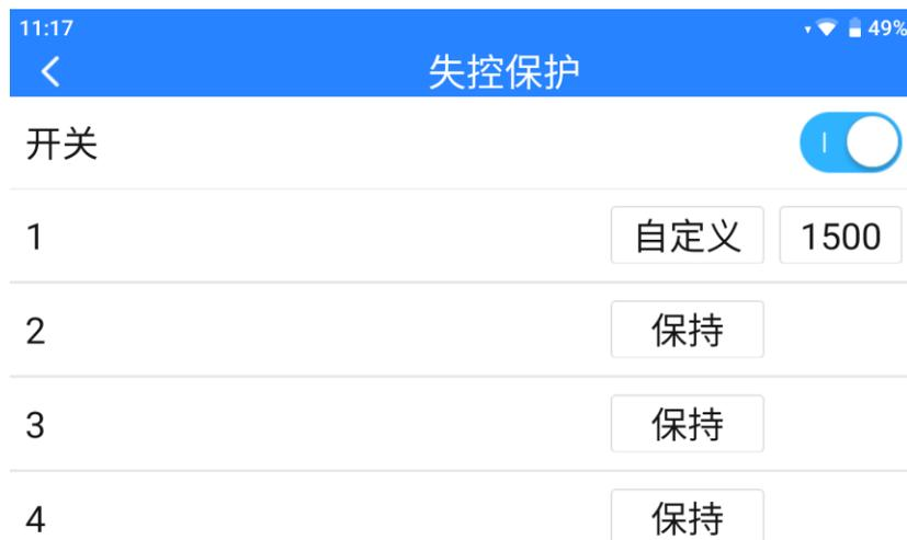
5. 设置完成后，当遥控器与天空端丢失连接时，该通道将输出设定好的行程量。
